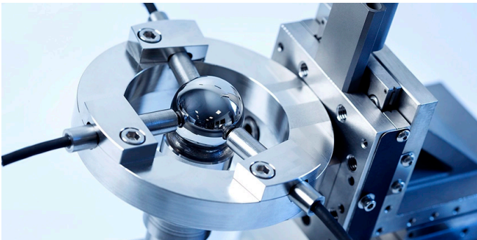
Abbildung 3: MPA: Drei Sensoren in unterschiedlichen Winkelpositionen auf das Target ausgerichtet
