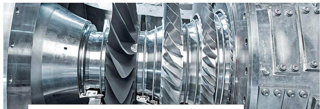
Die Turbinenfertigung bei MTU ist ein hochkomplexer, hochpräziser Prozess, der echtes 6-Achs Schleifen erfordert.
